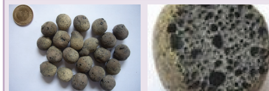
圖9 1100°C-5min 輕質粒料外觀及剖面
