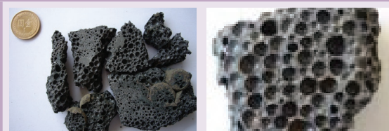
圖13 1150°C-5min輕質粒料外觀及剖面
