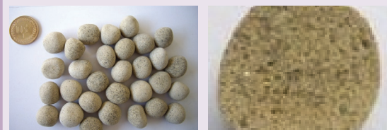
圖5 1050°C-5min 輕質粒料外觀及剖面
