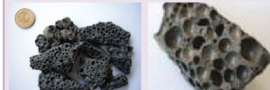
圖12 1125°C-15min 輕質粒料外觀及剖面
