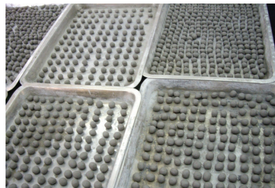
圖4 石材廢泥造粒成品
