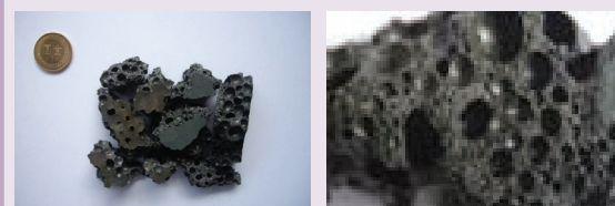
圖14 1150°C-15min輕質粒料外觀及剖面
