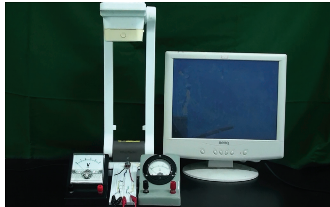
圖3 實驗裝置圖：圖的左上方為實物投影機，右上方為螢幕，下方為白色的麵包板，左右各為伏特計和安培計。
