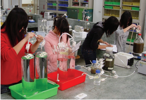
步驟六 利用矽膠管將各裝置串聯
