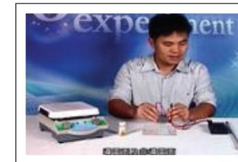
Step2. 配向膜製作，滴入配膜溶液於導電玻璃導電面，用塗佈棒均勻塗佈，並放置加熱盤上加熱250°C十分鐘，將配向膜烤乾。
