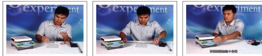
Step3. 配向膜凹槽製作，將具有配向膜之導電玻璃，利用玻璃切割刀割出適當大小，利用800號砂紙，單向刮出溝槽，目的讓液晶有配向。
