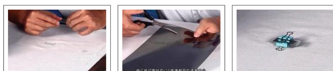
Step5. 將液晶晶胞加入電場，置於燈箱上即可觀察到液晶表面電場控制變化情形，而後兩圖為學生延伸研究發展出不需偏光片即可觀察到色彩變化的現象。
