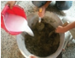
Step 2 水泥砂漿摻入奈米材料
