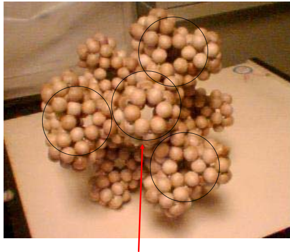
每一個圈是一個sodalite之位置，紅箭頭標的中間這一個往下方各接了三個，它的上方還可再接一個
