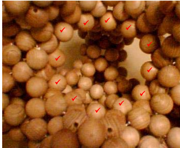
這是faujasite以近距離觀察其上由十二顆氧原子圍出的十二元環 (圖中打勾的)
