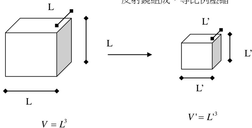
絕熱壓縮， $PV^\gamma$  為定值，若以輻射為介質  $\gamma = 4/3$
