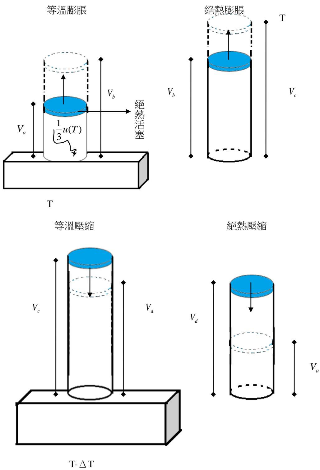
注意:在等溫膨脹時，熱輻射將高溫熱庫的熱帶入，同時也補充熱機工作的媒介(在一般的卡諾熱機則為氣體時)
